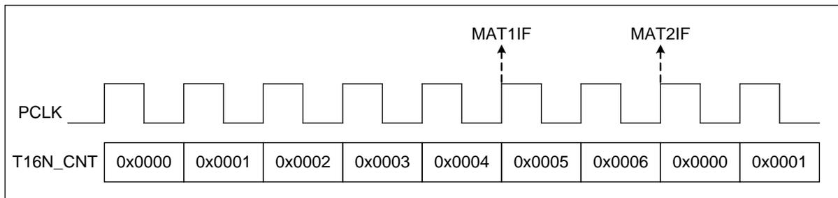
图 5-2 T16N 计数匹配功能示意图
