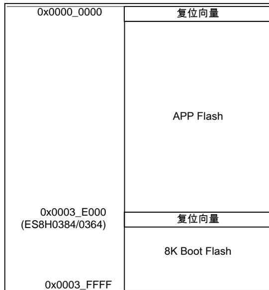
图 3-2 Boot Flash 启动地址分配示意图
