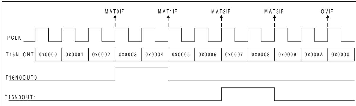
图 5-4 T16N 输出调制功能示意图
