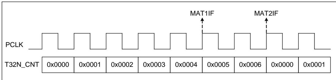
图 5-6 T32N 计数匹配功能示意图
