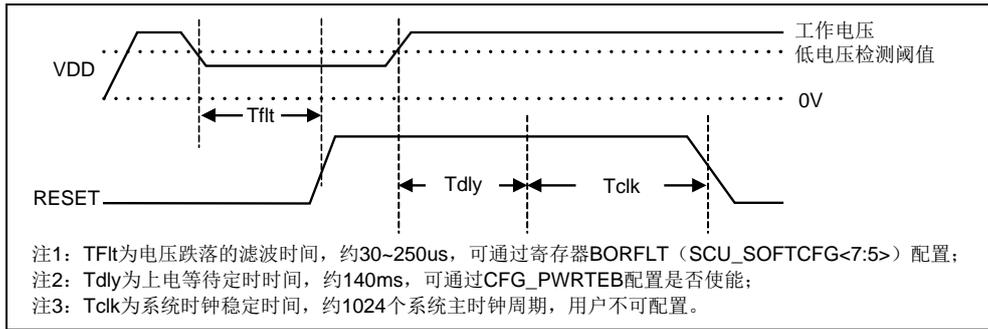
图 2-4 掉电复位时序示意图
