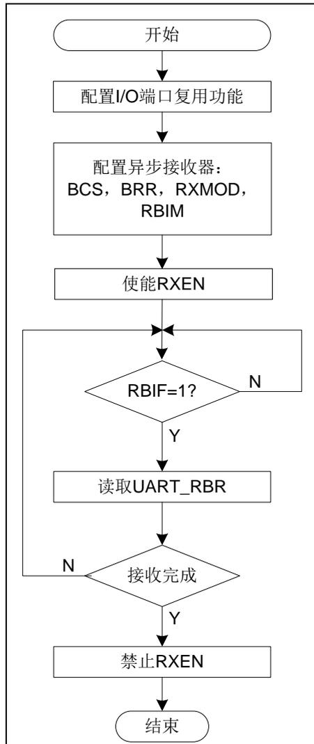
图 5-18 UART 接收数据操作流程图示例
