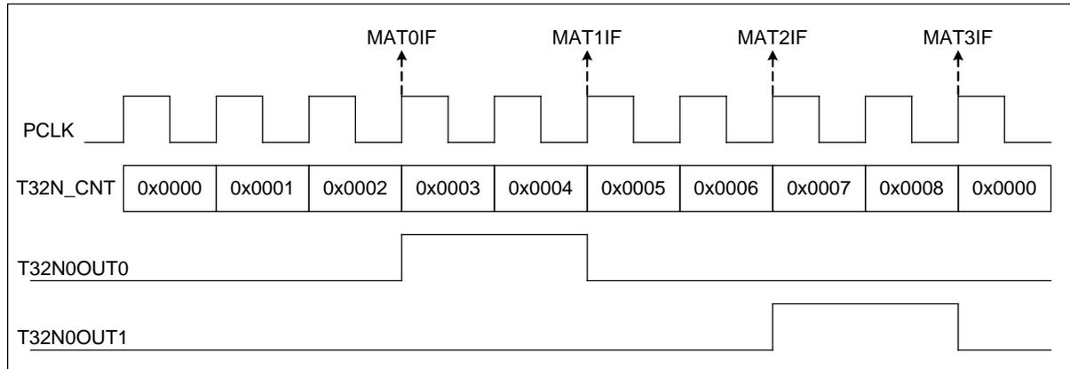
图 5-8 T32N 输出调制功能示意图
