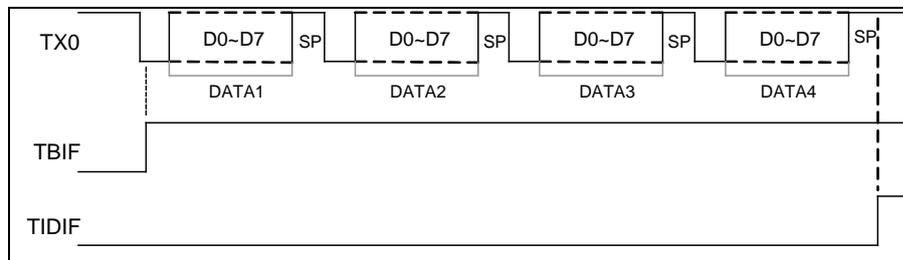
图 5-14 UART 发送中断标志示意图
