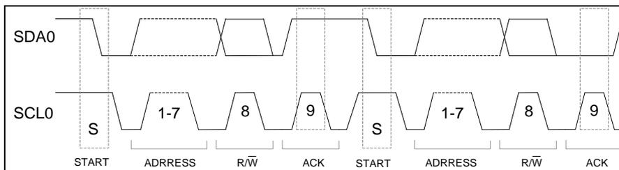
图 5-42 I2C 自动寻呼波形图
