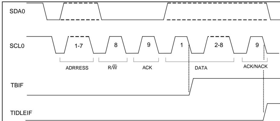
图 5-38 I2C 发送中断标志示意图
