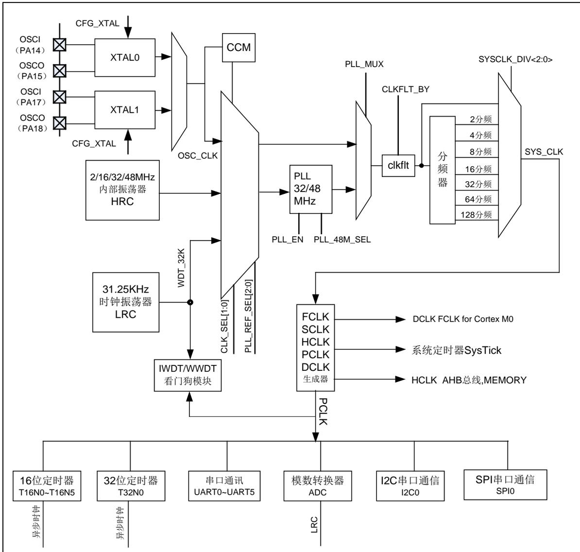
图 2-11 系统时钟电路结构框图
