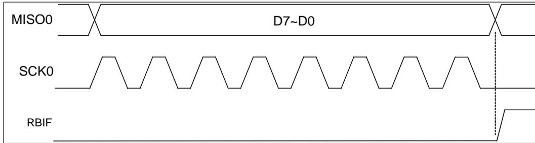
图 5-29 SPI 接收中断标志示意图
