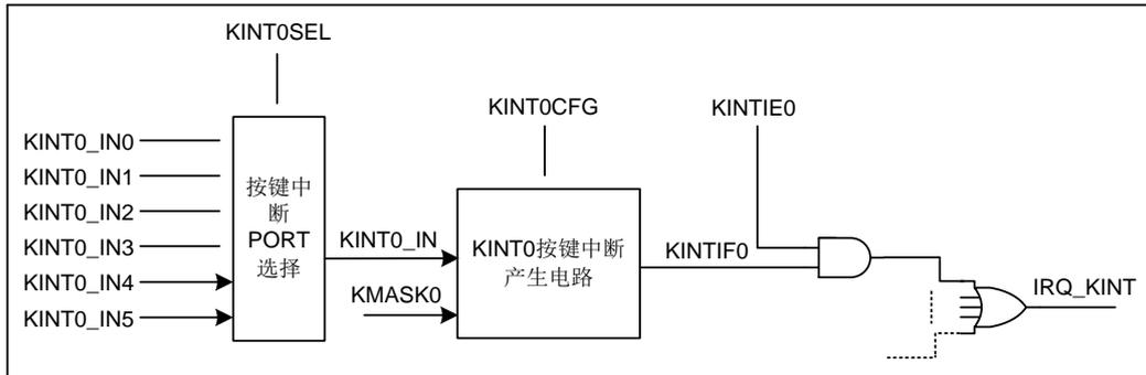
图 4-3 外部按键中断 KINT 电路结构示意图
