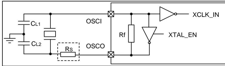
图 2-12 XTAL 振荡器电路结构示意图
