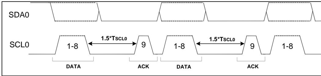
图 5-44 I2C 应答延迟功能波形示意图
