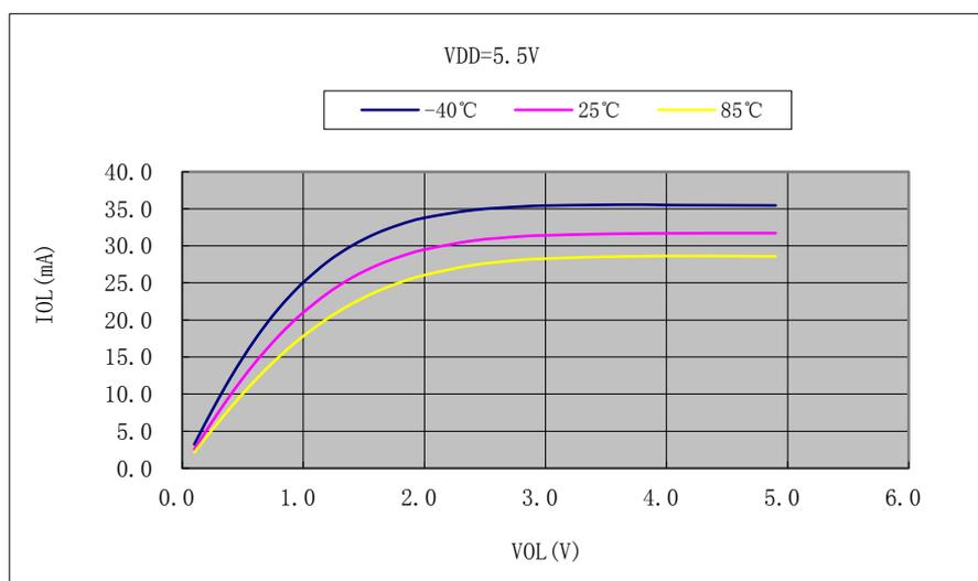
附录2.2.4 芯片IO端口输出特性（增强驱动，PA0~PA3 端口除外）
