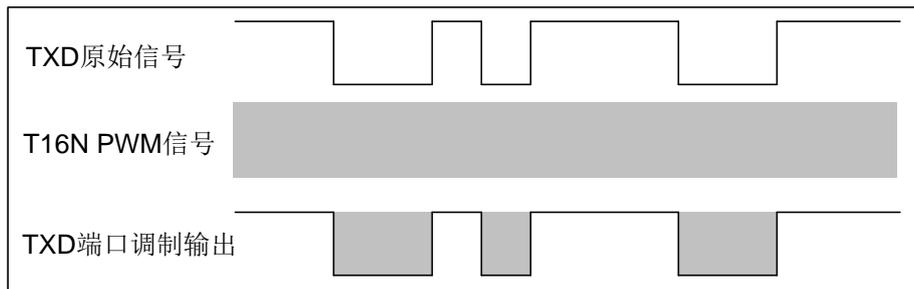
图 5-20 低电平调制输出波形图
