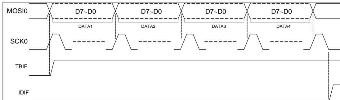
图 5-27 SPI 发送中断标志示意图
