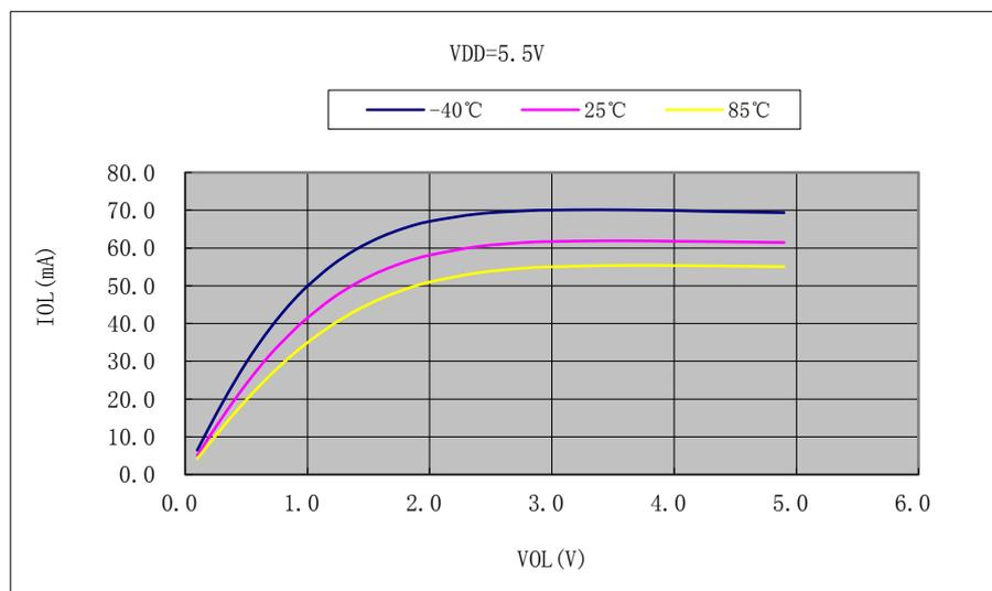
附录2.2.5 芯片IO端口输出特性（普通驱动，PA0~PA3 端口）
