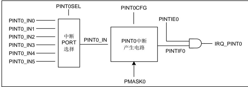
图 4-2 外部端口中断 PINT0 电路结构示意图
