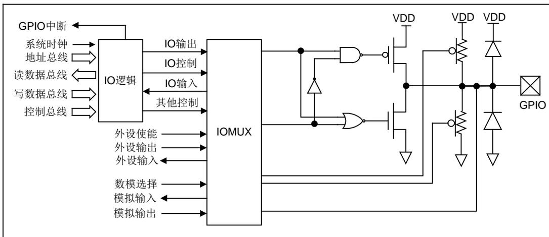
图 4-1 IO 端口电流结构图
