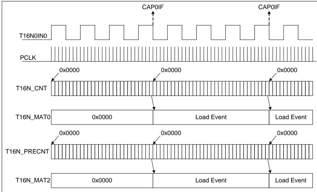
图 5-3 T16N0 捕捉功能示意图
