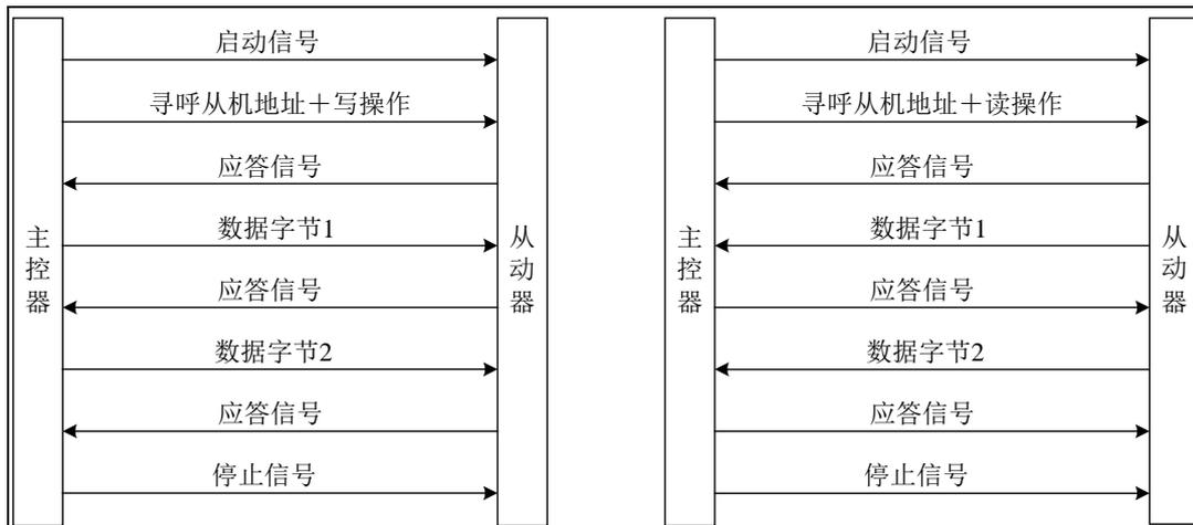
图 5-32 I2C 总线通讯协议示意图
