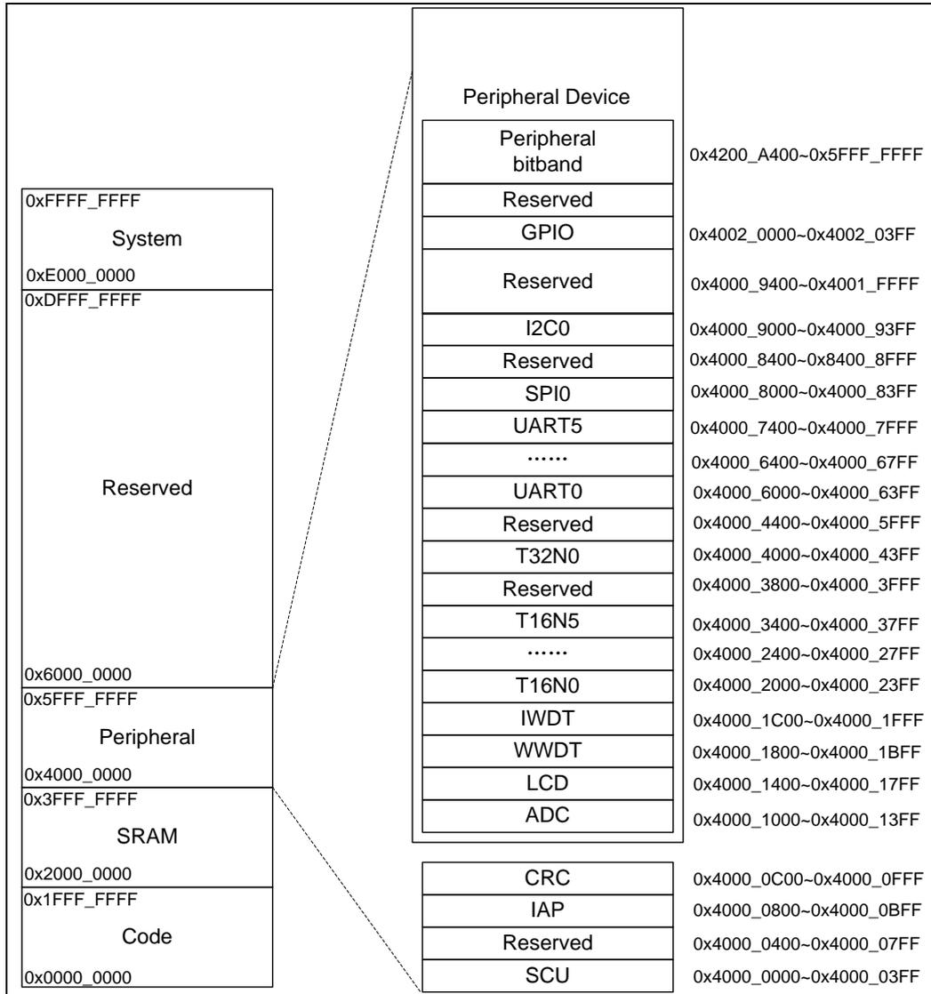
图 3-4 外设存储器分配示意图
