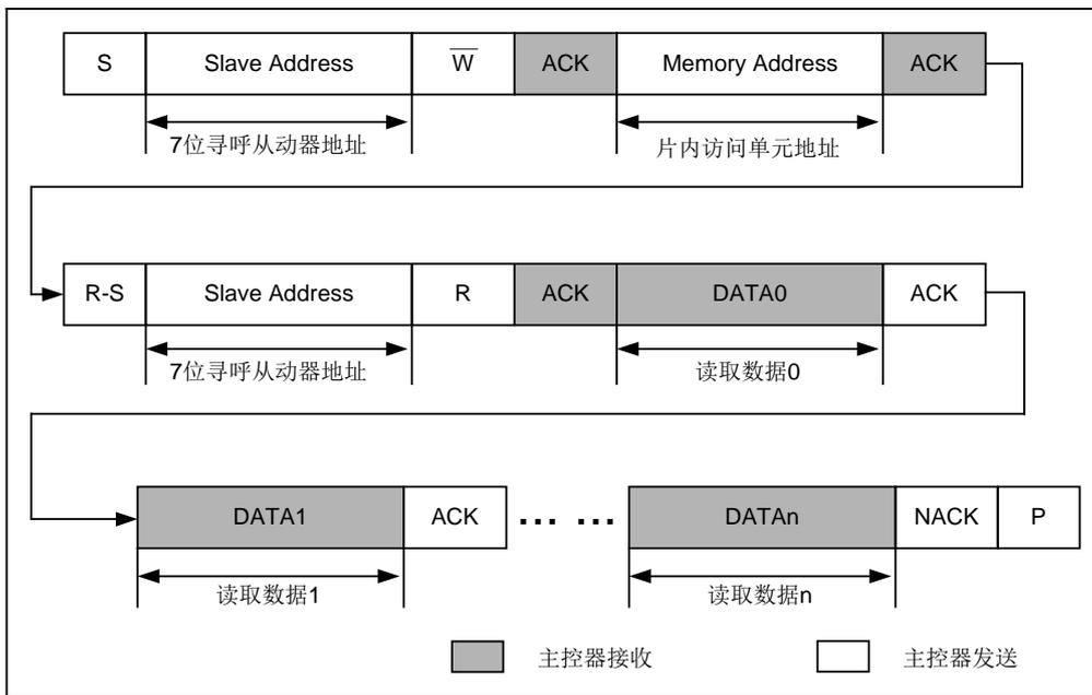
图 5-34 I2C 主控器读取从动器数据示意图
