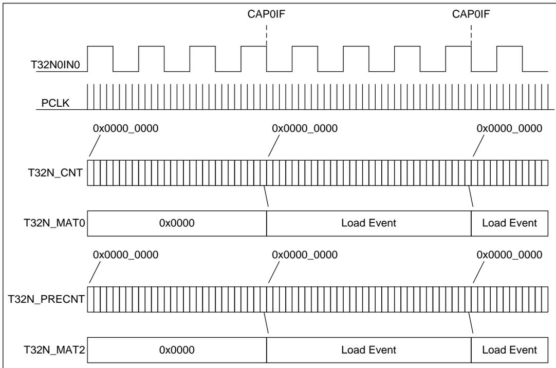
图 5-7 T32N 捕捉功能示意图
