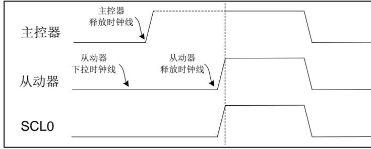
图 5-46 I2C 时钟线下拉等待波形示意图
