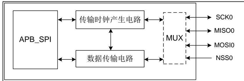
图 5-21 SPI 电路结构框图
