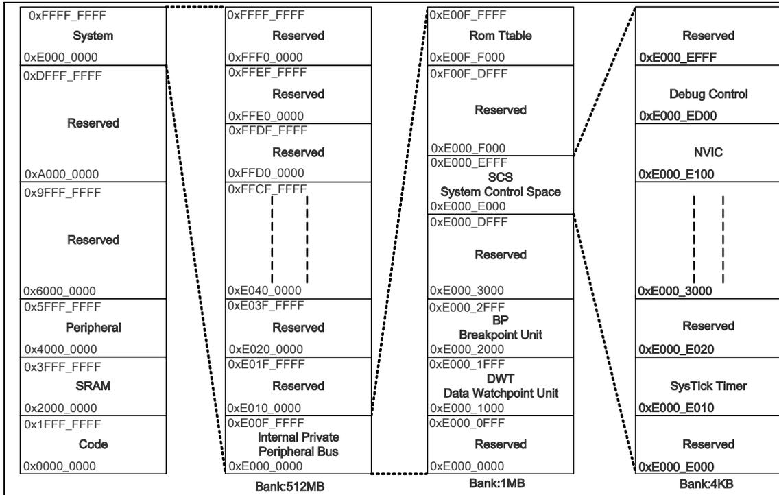
图 3-1 内部存储系统分配示意图
