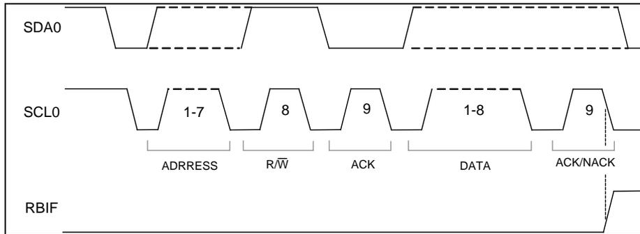
图 5-40 I2C 接收中断标志示意图
