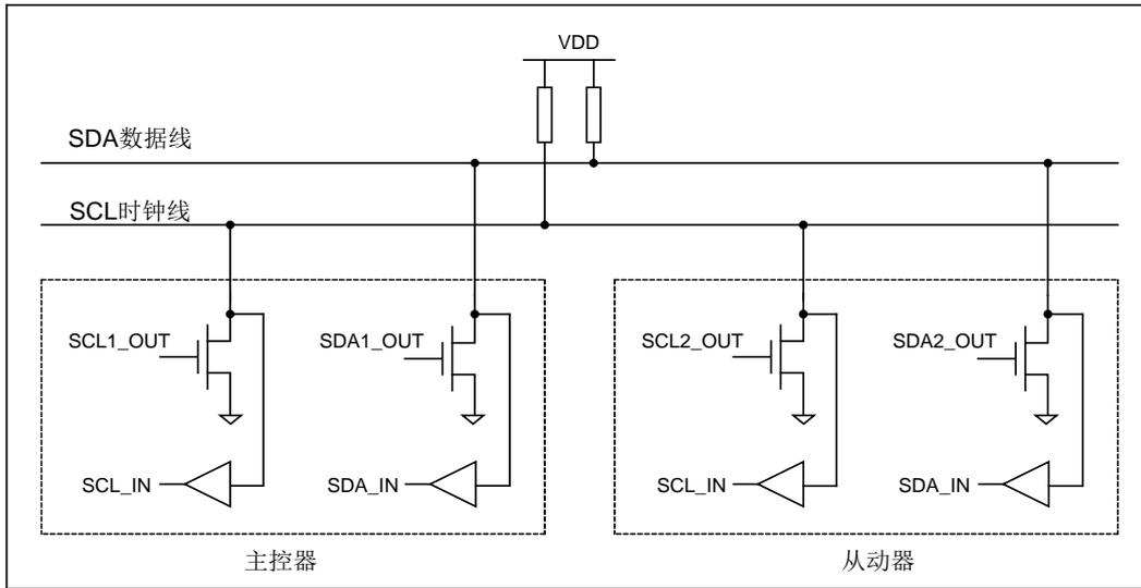
图 5-35 开漏输出端口示意图
