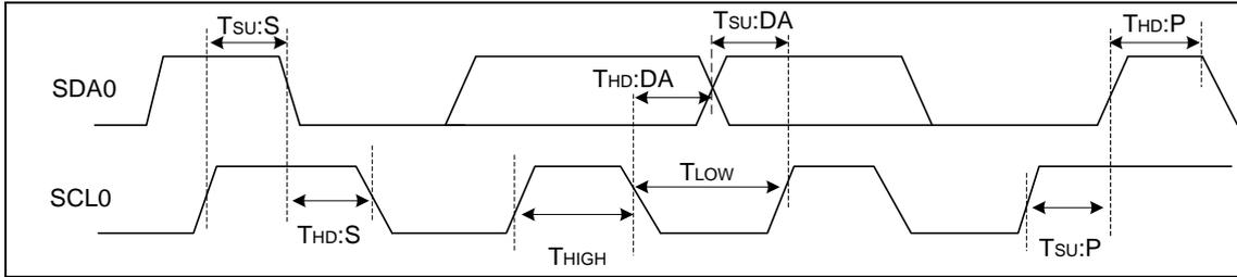
图 5-36 I2C 总线端口信号的波形示意图
