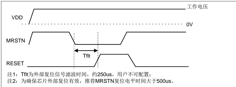
图 2-5 外部复位时序示意图
