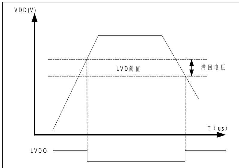
图 2-10 LVD 低电压监测示意图
