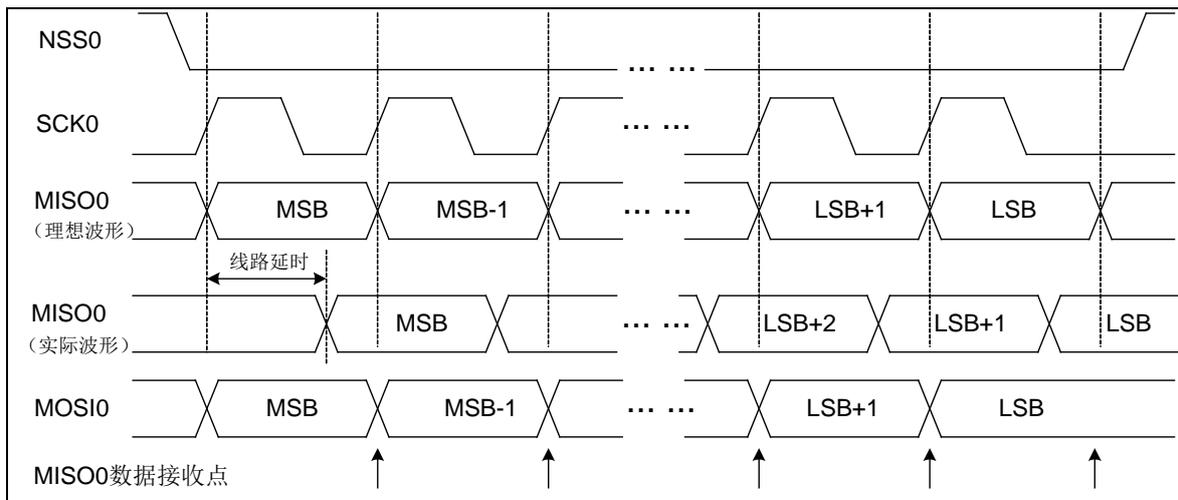
图 5-30 SPI 延迟接收功能波形示意图
