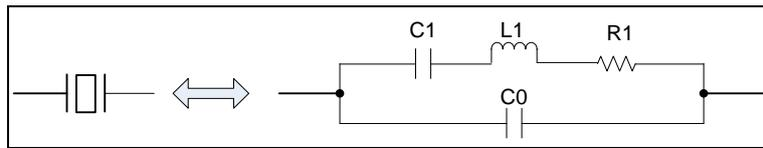
图 2-13 晶体振荡器等效电路示意图
