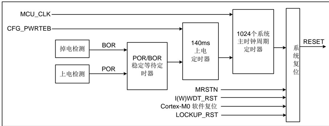
图 2-2 系统复位电路结构框图
