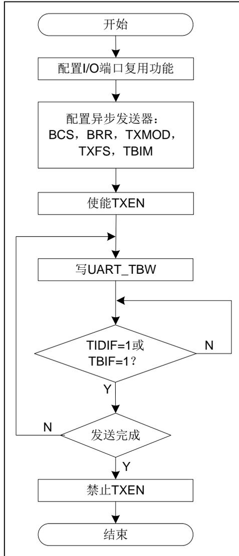
图 5-15 UART 发送数据操作流程图示例
