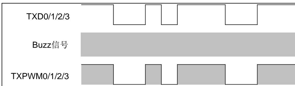
图 4-4 Buzz 高电平调制输出波形图
