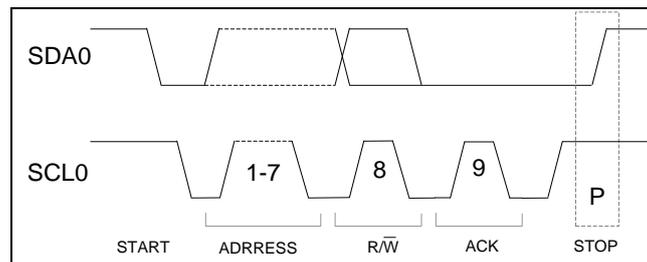
图 5-43 I2C 停止位波形图
