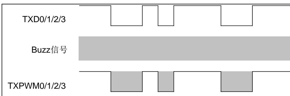
图 4-5 Buzz 低电平调制输出波形图
