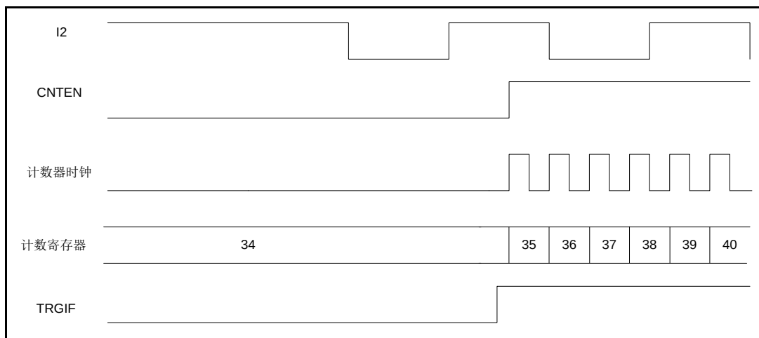
图 17-25 触发模式控制电路
