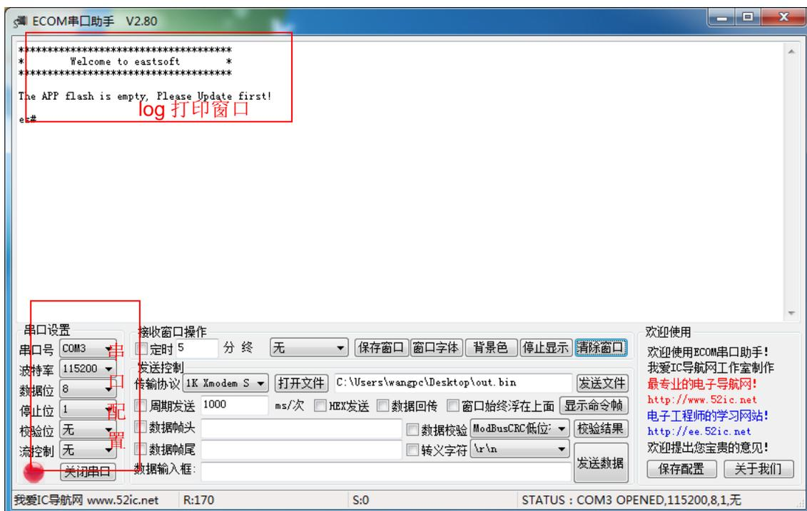
图 2-1 Bootloader 上电复位 log 图
