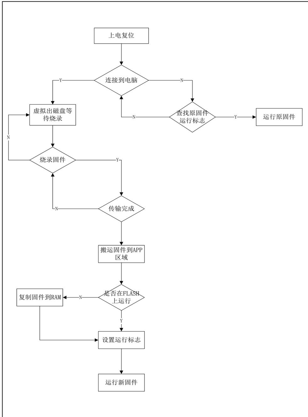
图 3-2 Bootloader 启动流程图
