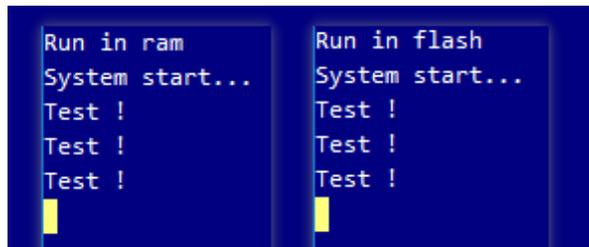
图 4-3 固件更新成功示例图
