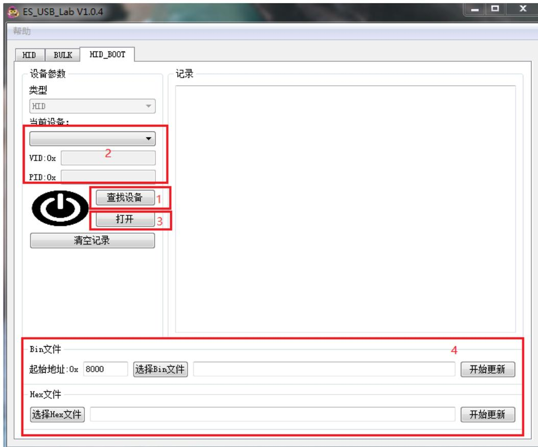
图 5-2 上位机软件设置流程图
