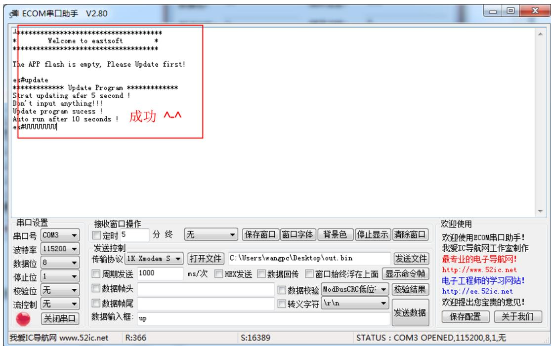
图 2-3 固件更新成功示例图
