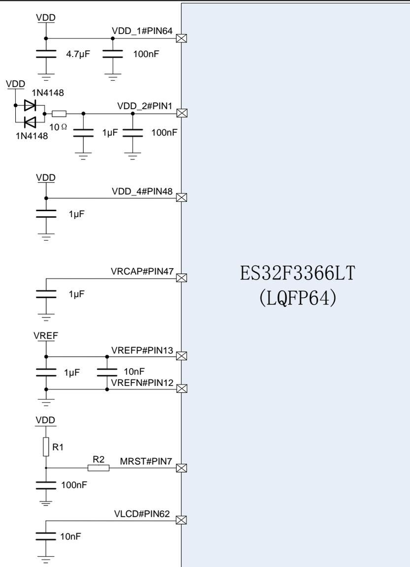
图 4-2 LQFP64 封装芯片最小系统电路
