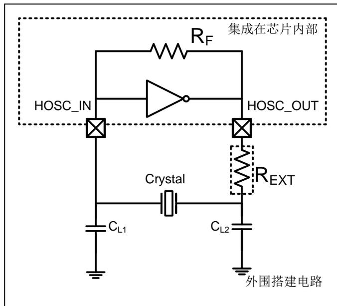
图 2-1 外部高速振荡器连接图
