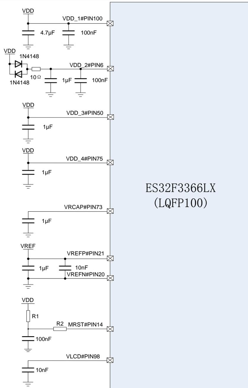
图 4-1 LQFP100 封装芯片最小系统电路
