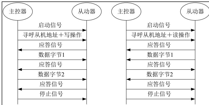
图 6-44 I2C 总线通讯协议示意图
