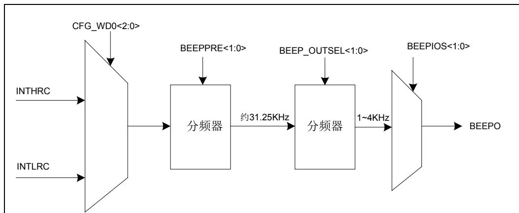
图 5.1 BEEPER 结构图
