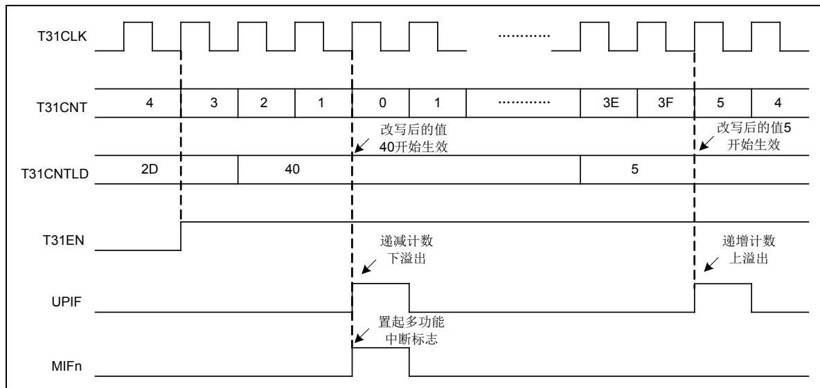
图 6-19 中心对齐模式 1 计数时序图 (RLBE=1)
