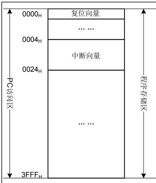
图 3-1 FLASH 程序存储区寻址空间映射图
