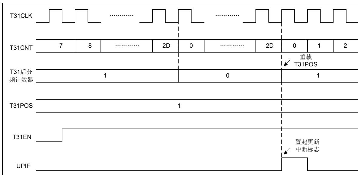
图 6-14 使用后分频的计数时序图 (T31CNTLD=0x2D)
