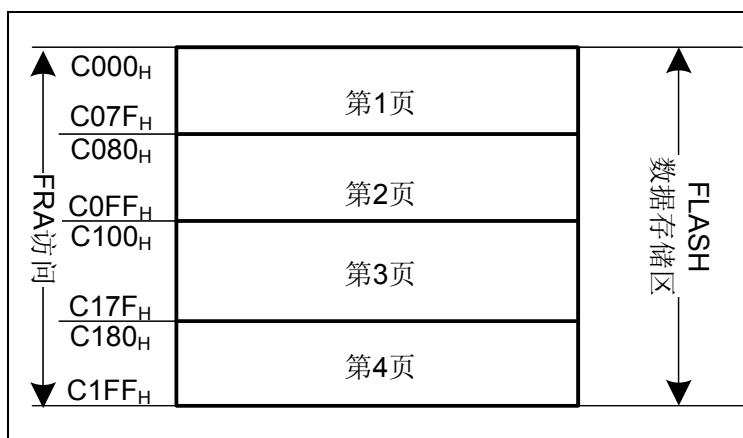
图 3-2 FLASH 数据存储区寻址空间映射图
