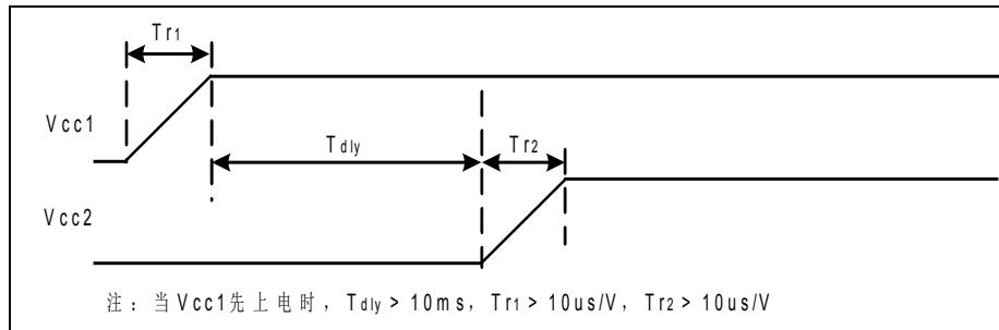
2) 如果 Vcc2 先上电，则 Vcc2 的上电速率需大于  $200\mu\text{s}/\text{V}$  (即当  $\text{Vcc2}=5\text{V}$  时，上电时间需大于  $1\text{ms}$ )；如果 Vcc2 与 Vcc1 同时上电，则上电速率也需大于  $200\mu\text{s}/\text{V}$ 。
