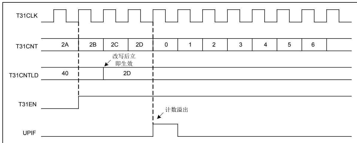
图 6-17 递增计数时序图 (RLBE=0, T31CNTLD 无缓冲)
