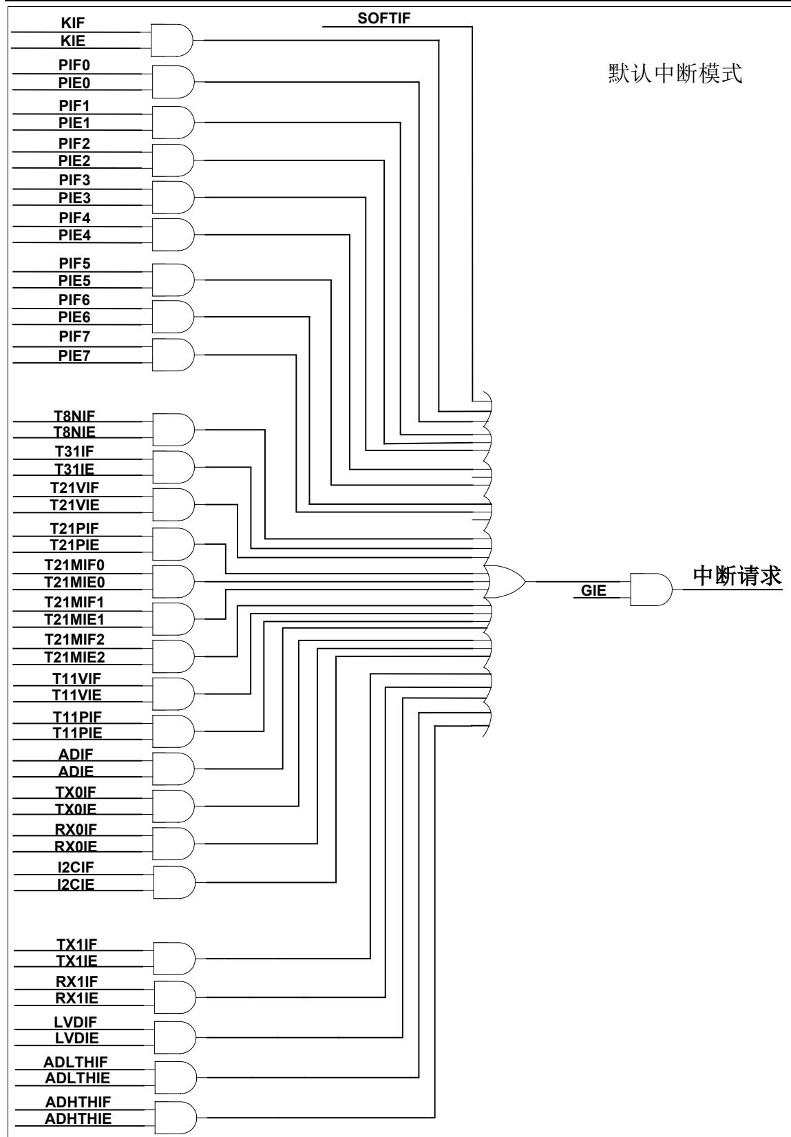
图 7-1 默认中断模式中断控制逻辑
