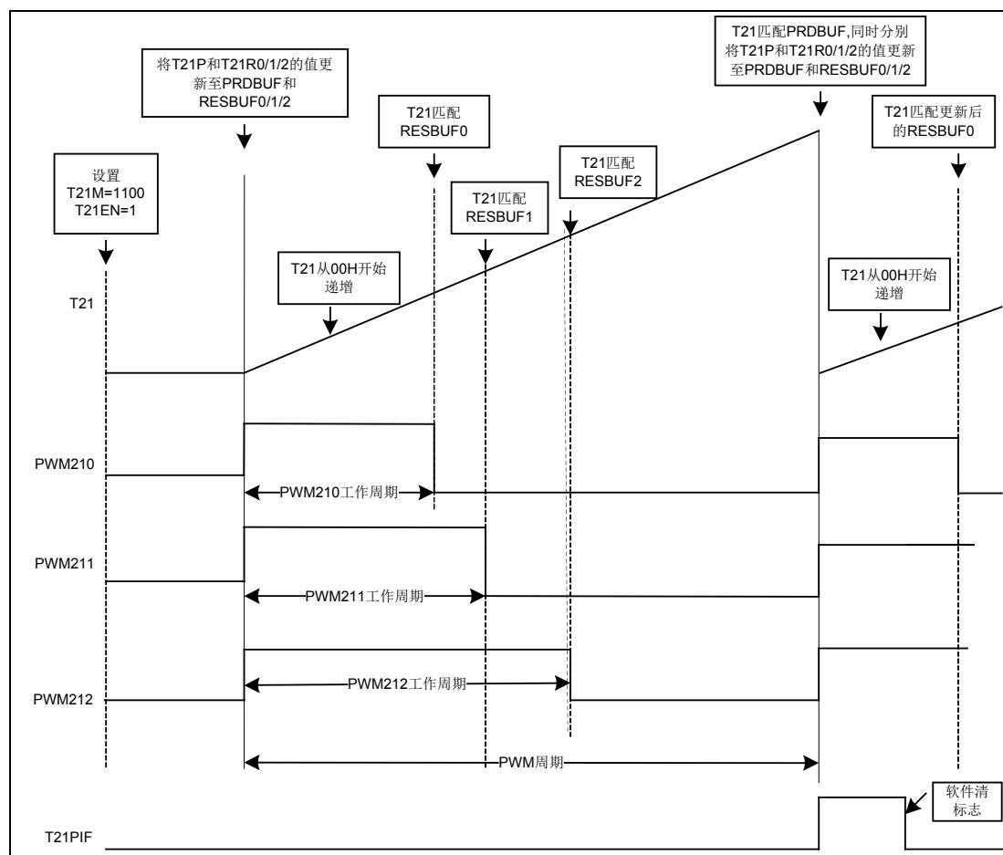
图 6-9 T21 多精度 PWM 模式示意图
