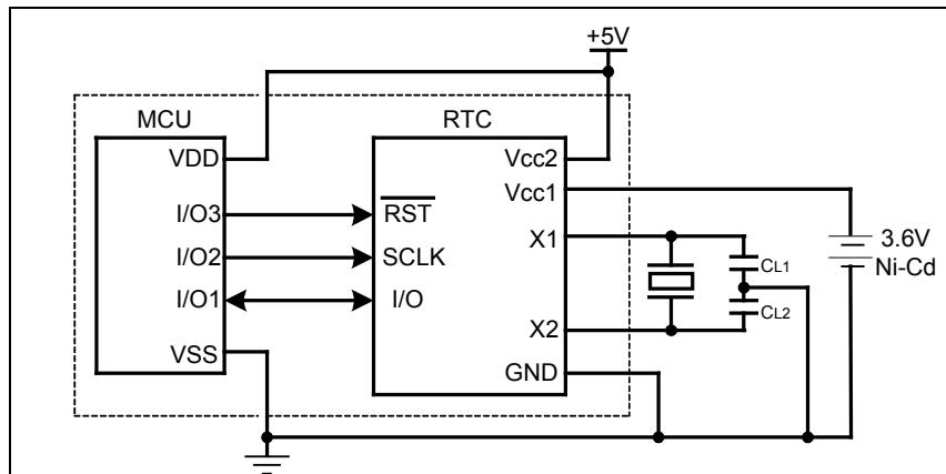
注 1：CL1 和 CL2 为晶振匹配电容，对  $32.768\text{KHz}$  晶振，推荐 CL1 和 CL2 电容值为  $6\text{pF}$ ，具体电容值可根据外接晶振的参数需求确定。
