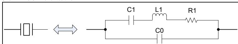
注 1：C1：动态电容；L1：动态电感；R1 动态电阻；C0：静电容；等效串联电阻  $\text{ESR}=\text{R1} \times (1+\text{C0}/\text{C}_L)^2$ ， $\text{C}_L$  为负载电容。
