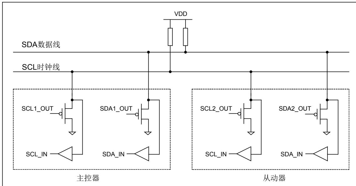
图 6-43 开漏输出端口示意图
