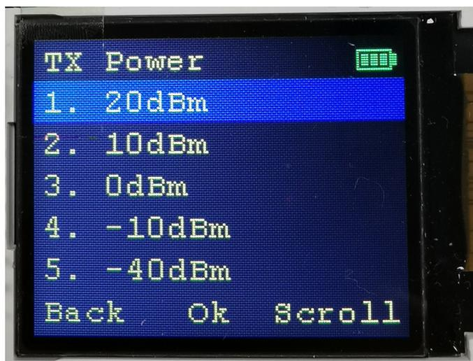
图 3-32 发射功率配置
