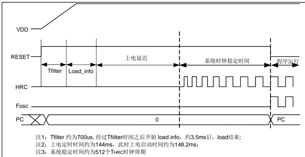
图 5-4 系统上电时序图 2 (MRSTN/PC1 配置为 GPIO)
