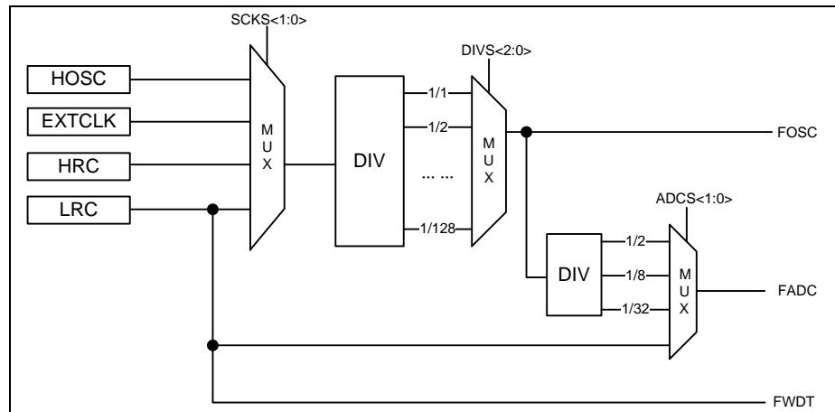
图 5-1 系统时钟内部结构图
