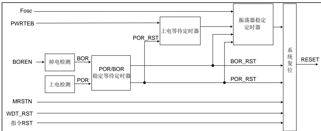
图 5-8 系统复位内部结构图
