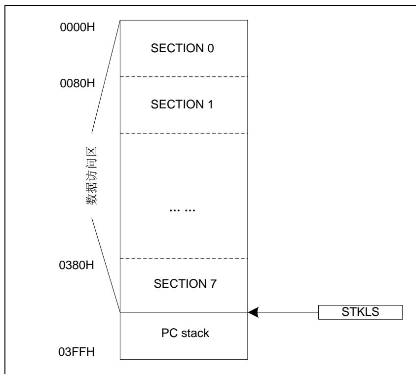
图 3-6 SRAM 地址映射示意图
