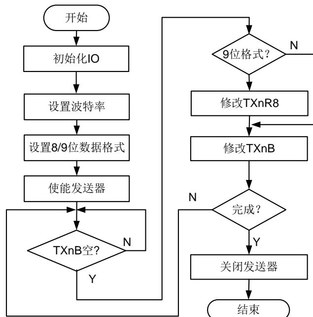
图 6-10 UARTn 发送器操作流程图
