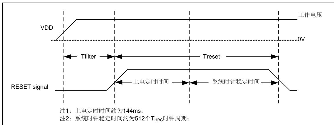
图 5-9 上电复位时序示意图
