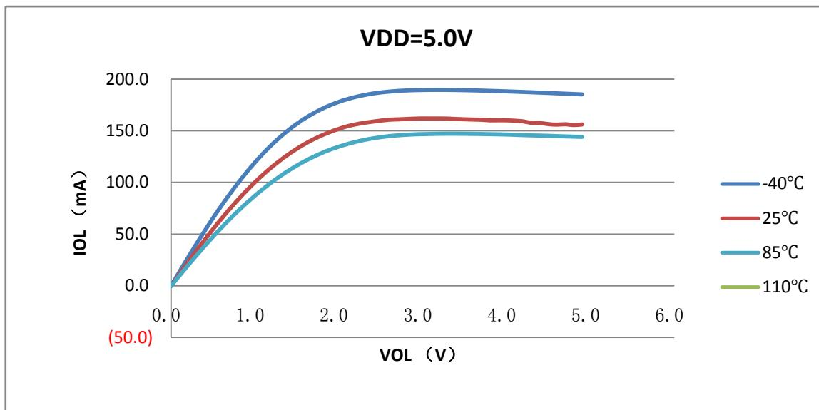
H:  $V_{OL}$  vs  $I_{OL}$  @VDD=5.0V 大电流端口强驱动模式
