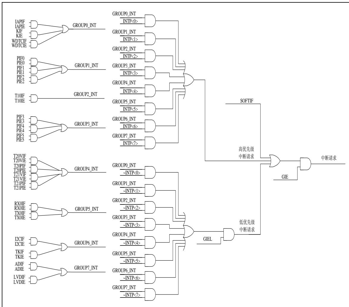
图 7-2 向量中断模式中断控制逻辑
