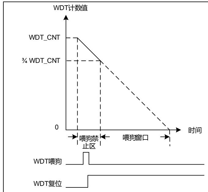
图 5-7 错误的喂狗时序图 (WDTCS 设定为 00)
