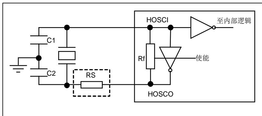
图 5-2 晶体/陶瓷振荡器模式 (HS、XT、LP 模式)
