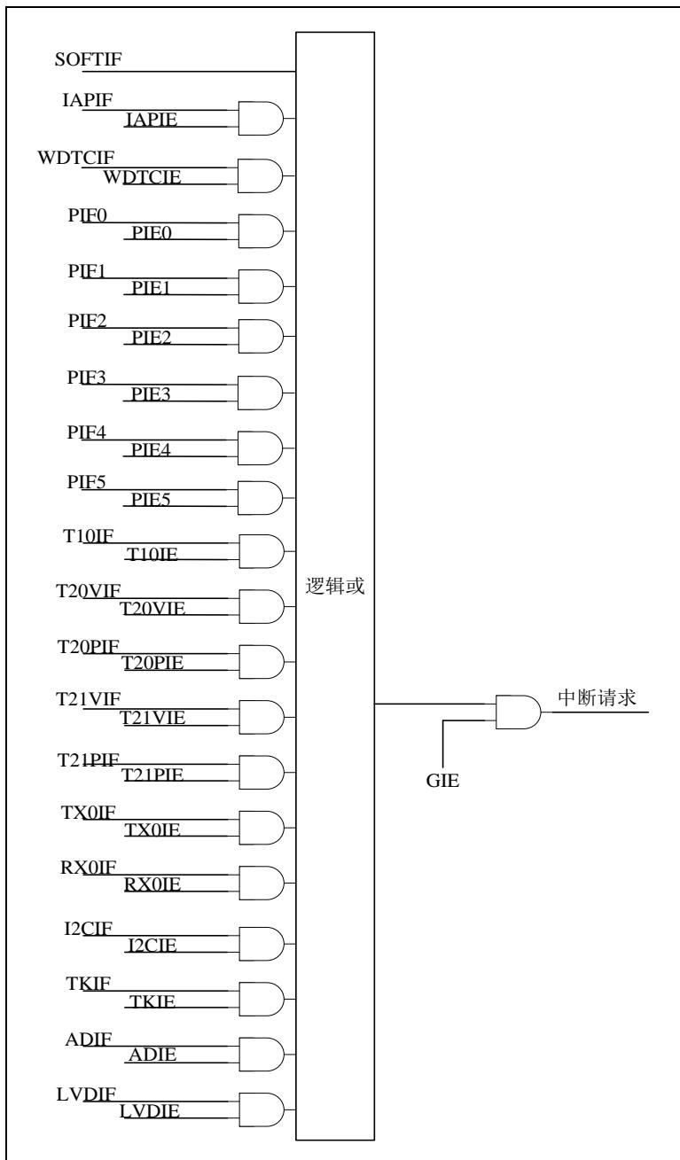
图 7-1 默认中断模式中断控制逻辑
