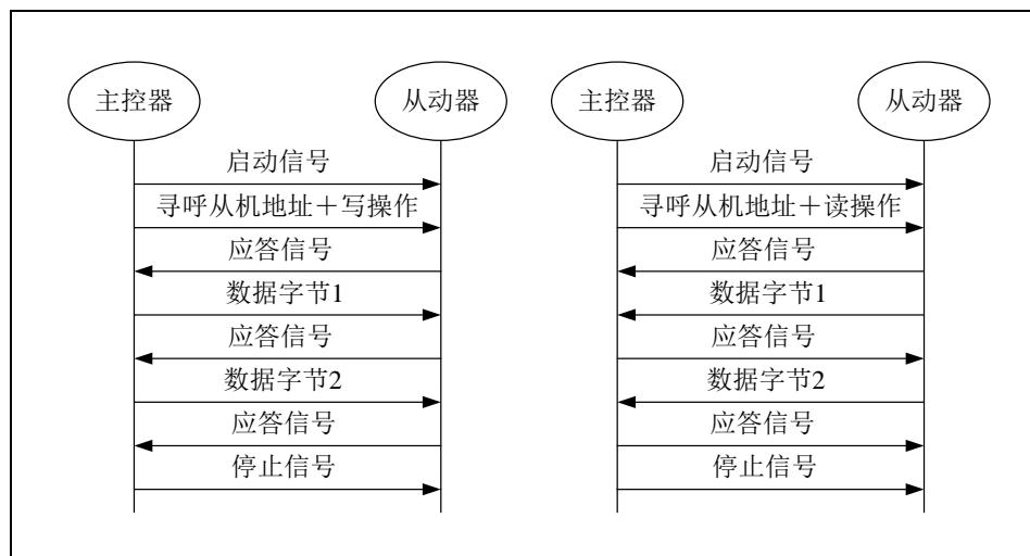
图 6-14 I2C 总线通讯协议示意图
