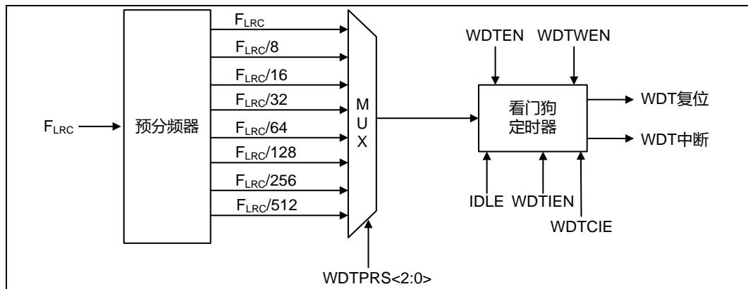
图 5-5 看门狗定时器内部结构图
