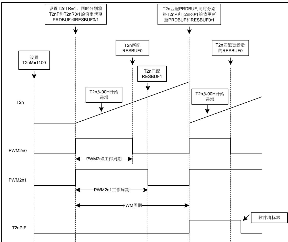
图 6-6 T2n 双精度 PWM 模式示意图
