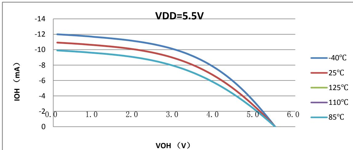
◆ I/O 端口信号输出特性图 ( $V_{OH}$  vs  $I_{OH}$  @ 12mA 源电流)
