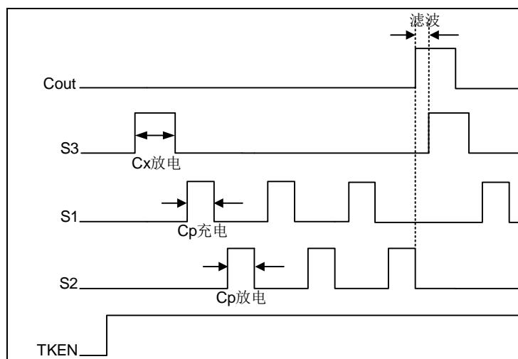
图 6-19 无触摸状态内部时序图
