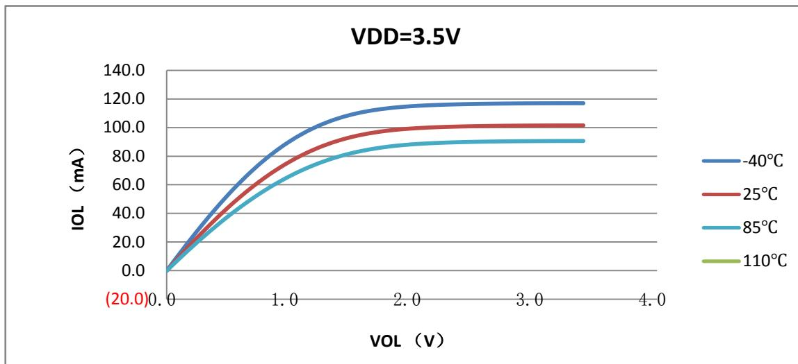
G:  $V_{OL}$  vs  $I_{OL}$  @VDD=3.5V 大电流端口强驱动模式
