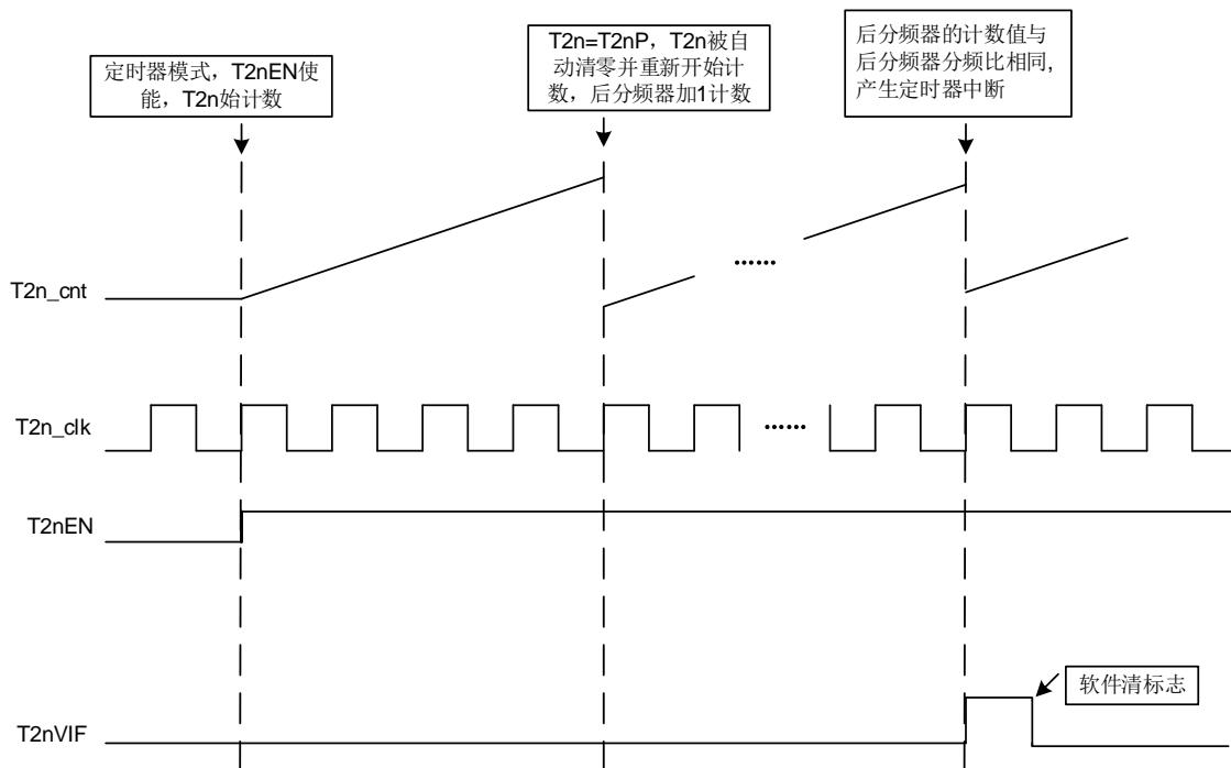
图 6-5 T2n 定时器模式时序图
