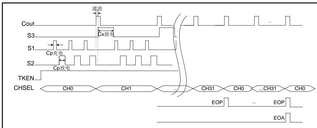
图 6-21 多通道轮询扫描内部时序图
