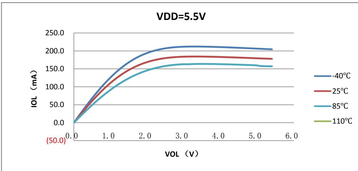
◆ I/O 端口信号输出特性图 2 (普通端口  $V_{OL}$  vs  $I_{OL}$ )
