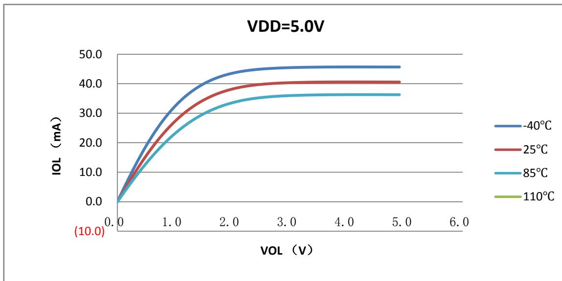
D:  $V_{OL}$  vs  $I_{OL}$  @ $VDD=5.5V$  大电流端口普通驱动模式
