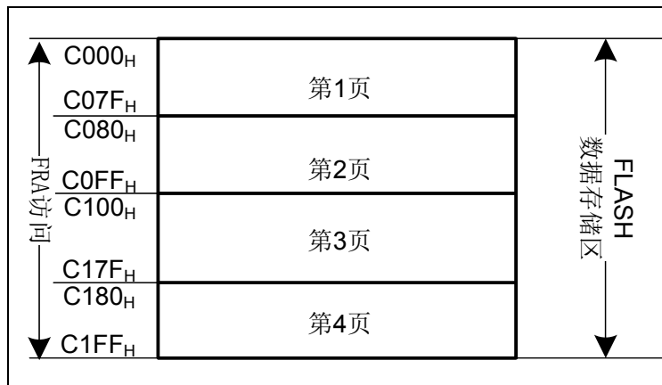
图 3-2 FLASH 数据存储区寻址空间映射图
