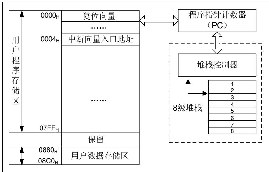
图 3-1 程序/数据区地址映射和堆栈示意图
