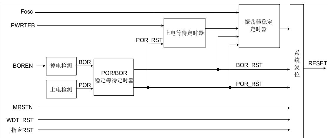
图 5-5 系统复位内部结构图
