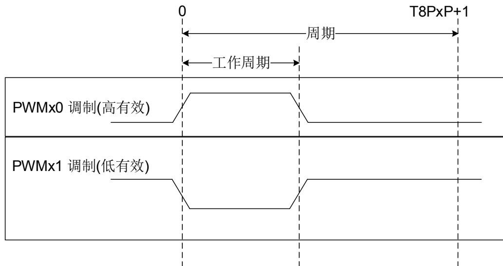
图 6-4 EPWM 单桥输出示意图
