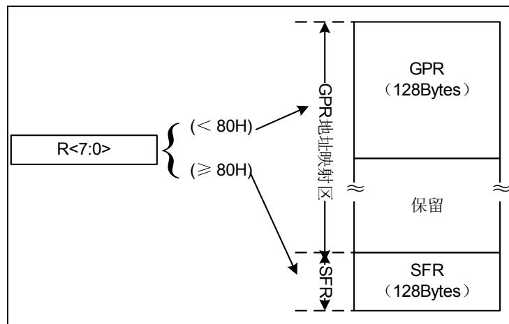
图 3-5 直接寻址示意图
