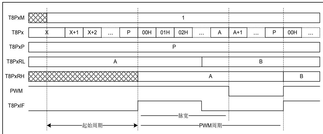
图 6-2 标准 PWM 输出示意图
