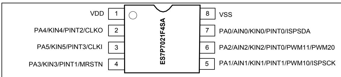
图 1-6 SOP8 封装顶视图
