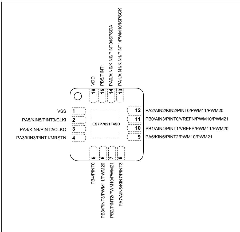
图 1-3 QFN16 封装顶视图
