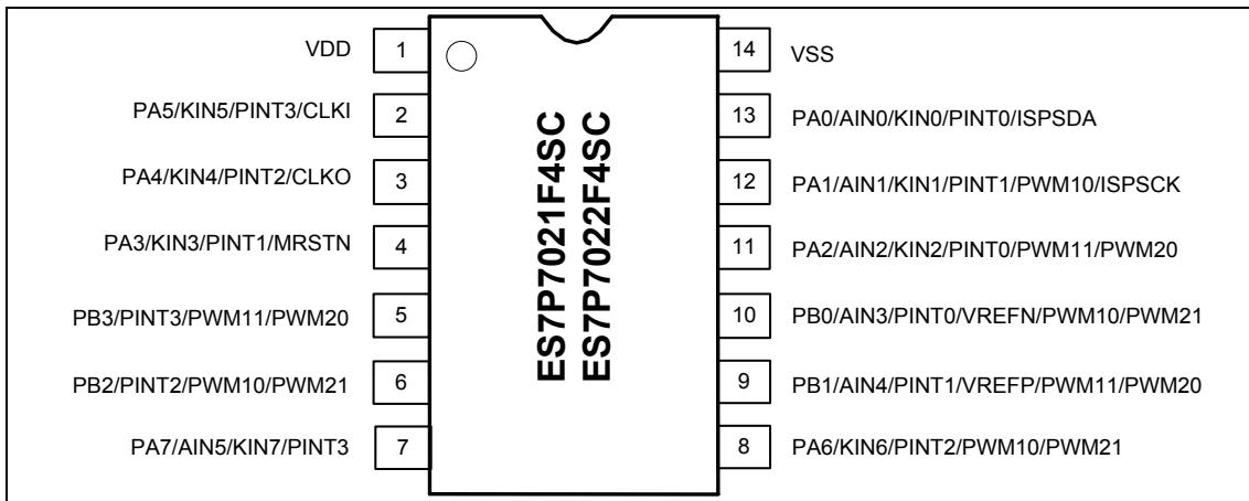
图 1-4 SOP14 封装顶视图
