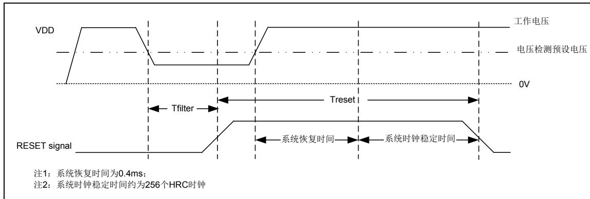
图 5-7 低电压复位时序示意图
