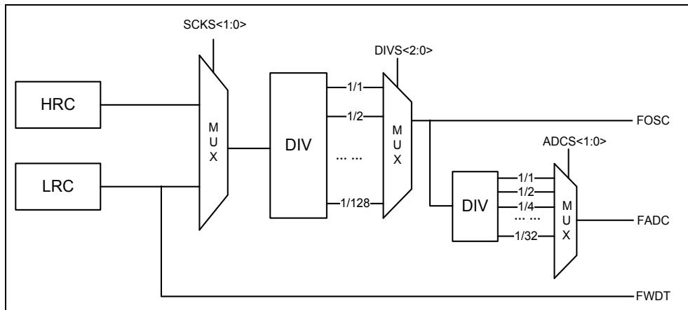
图 5-1 系统时钟内部结构图
