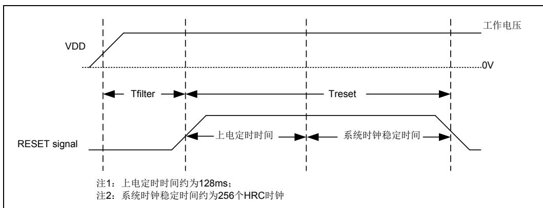
图 5-6 上电复位时序示意图
