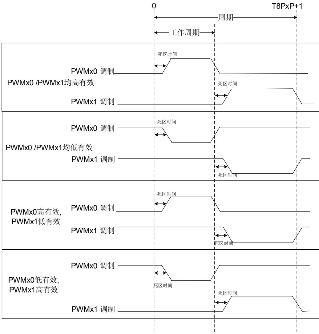
图 6-5 EPWM 半桥输出示意图
