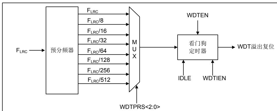
图 5-4 看门狗定时器内部结构图
