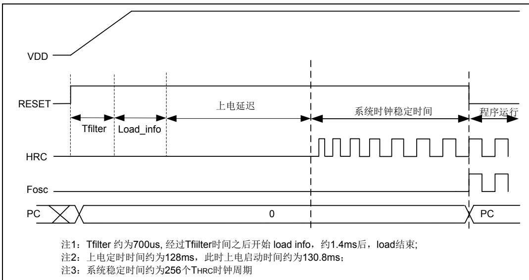
图 5-3 系统上电时序图 2 (MRSTN/PA3 配置为 GPIO)
