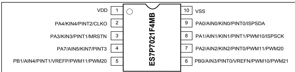
图 1-5 MSOP10 封装顶视图
