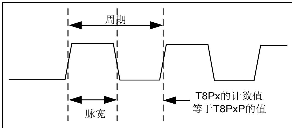
图 6-3 标准 PWM 输出示意图
