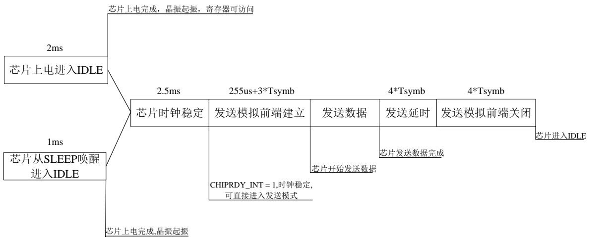
图 6-2 芯片上电进入发送模式示意图
