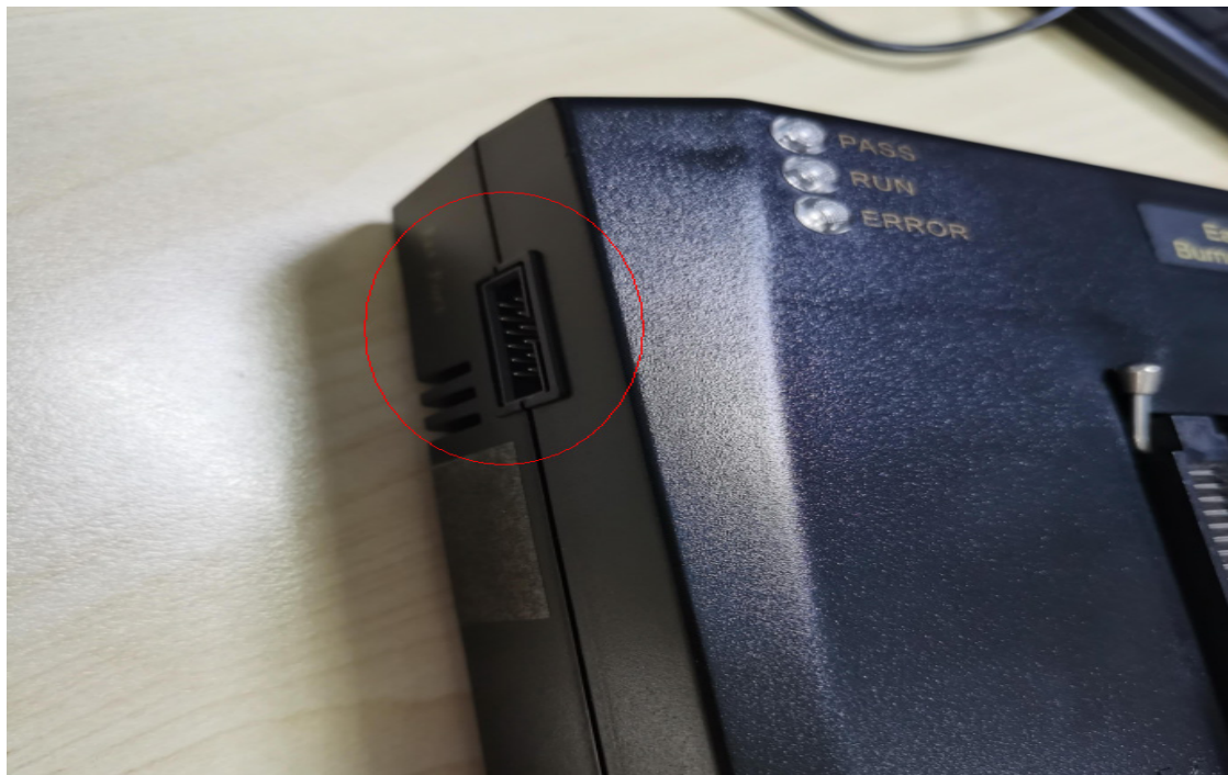
图表 2-1 ES60S 编程器预留自动烧录机台接口
