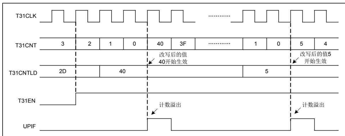
图 6-18 递减计数时序图 (RLBE=1, T31CNTLD 有缓冲)
