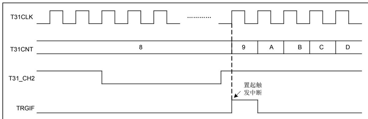
图 6-34 触发模式下的计数时序 (T31CNTLD=0x3F, 通道 2 端口信号上升沿触发)
