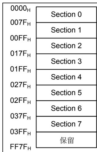
图 3-5 GPR 地址映射示意图
