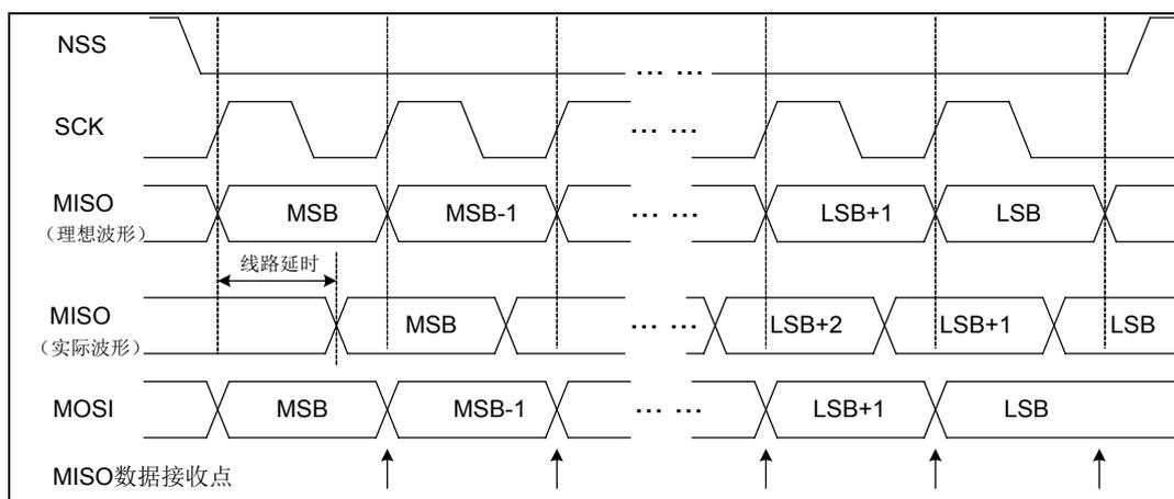
图 6-60 SPI 延迟接收功能波形示意图
