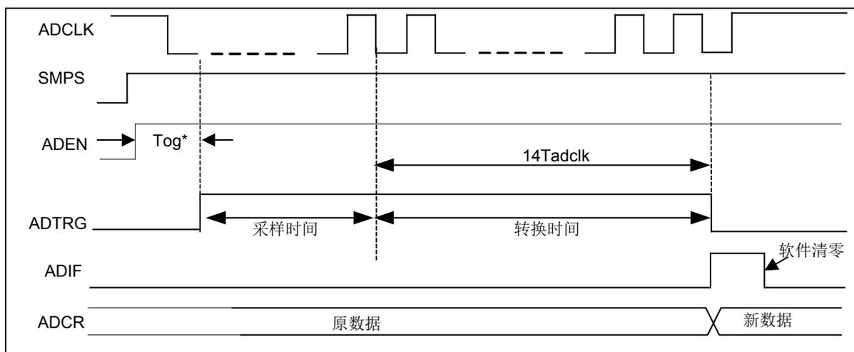
图 6-63 ADC 时序特征示意图 (SMPS=1)
