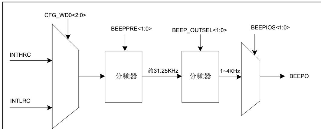
图 5.1 BEEPER 结构图
