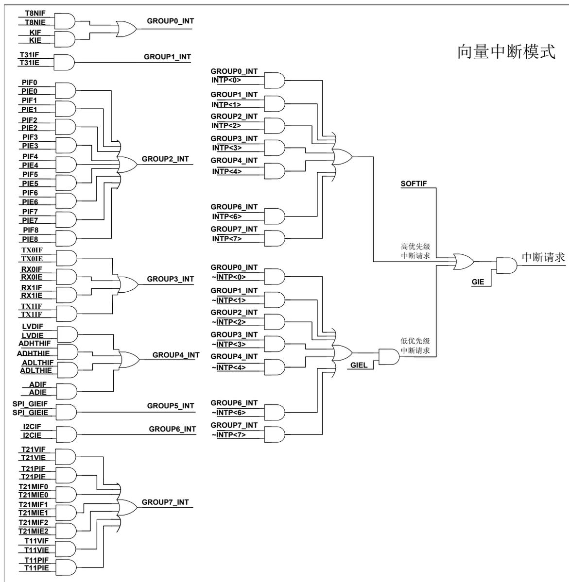
图 7-2 向量中断模式中中断控制逻辑
