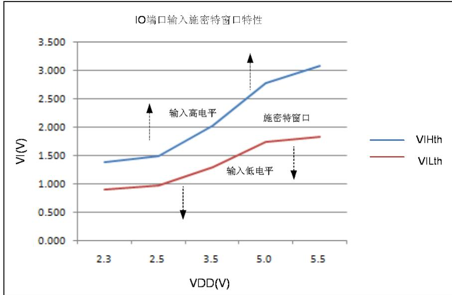
◆ I/O 端口 TTL 输入特性图（室温 25℃）
