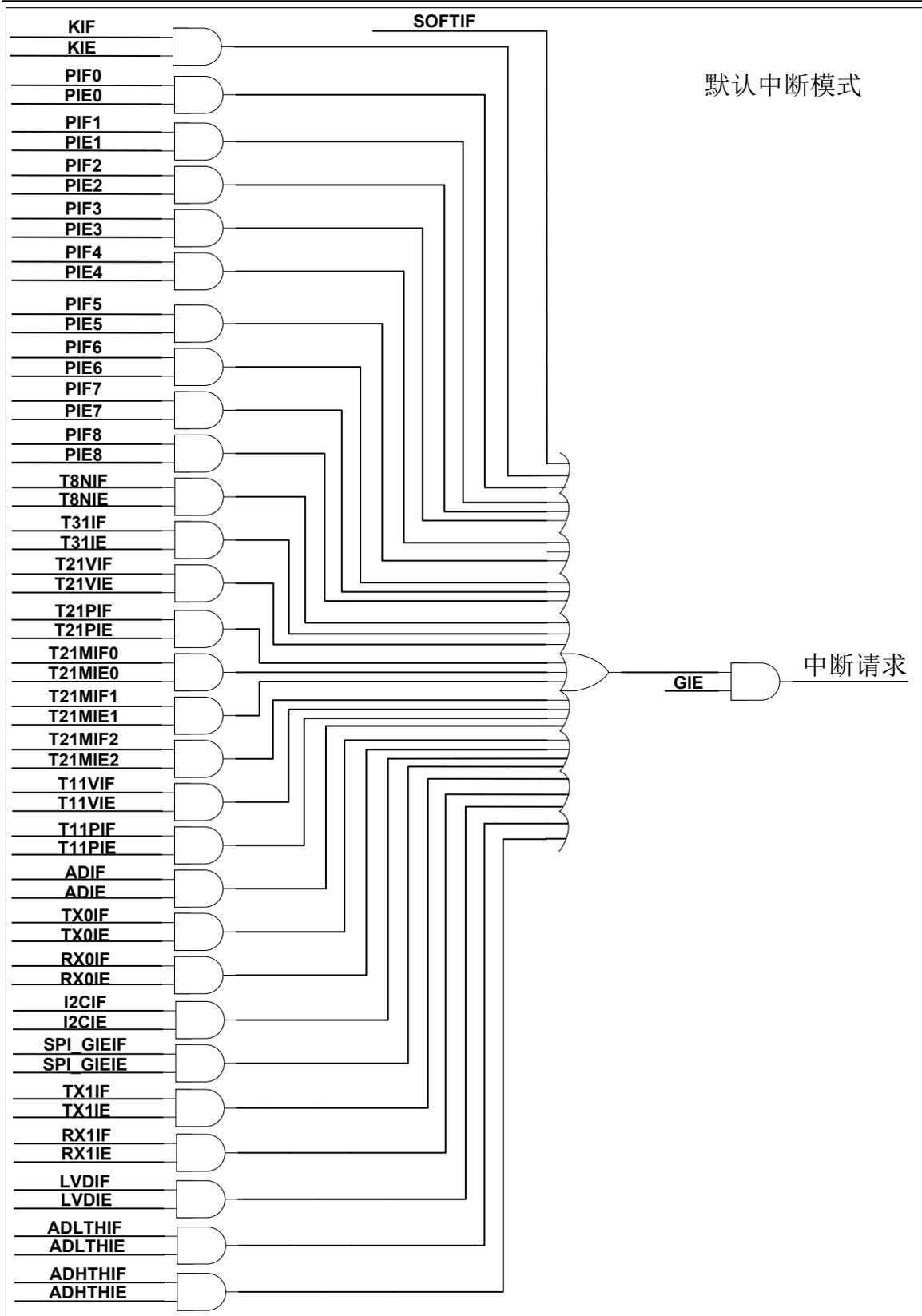
图 7-1 默认中断模式中中断控制逻辑
