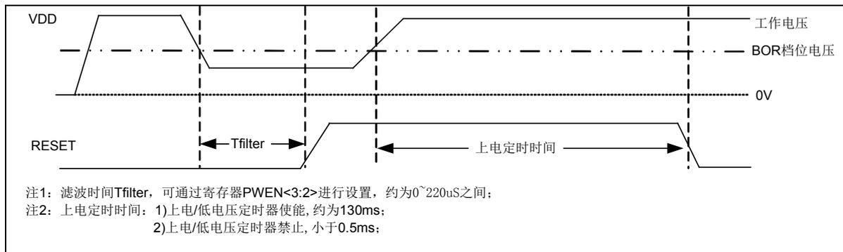
图 5-5 低电压复位时序示意图
