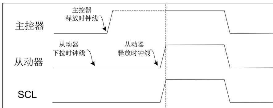
图 6-52 I2C 时钟线下拉等待波形示意图
