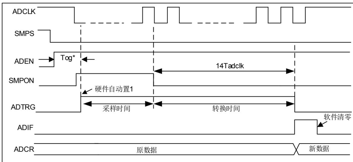
图 6-62 ADC 时序特征示意图 (SMPS=0)
