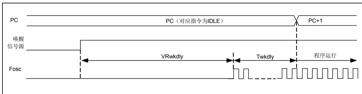
图 5-11 系统唤醒 IDLE 的时序图
