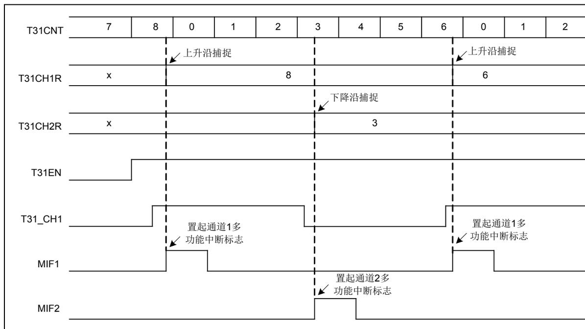
图 6-23 测量脉冲信号周期和占空比的捕捉模式时序（通道 1，复位模式）
