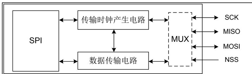
图 6-53 SPI 电路结构框图
