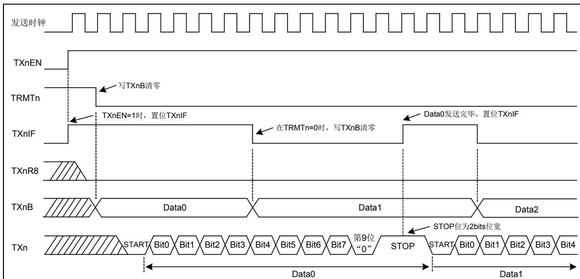
图 6-39 UARTn 发送器发送数据时序图 (9 位数据格式, 第 9 位数据为 “0”)
