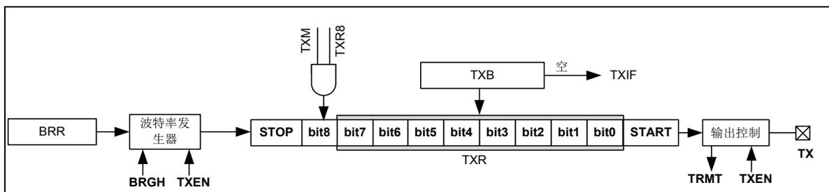
图 6-35 UART 发送端原理图
