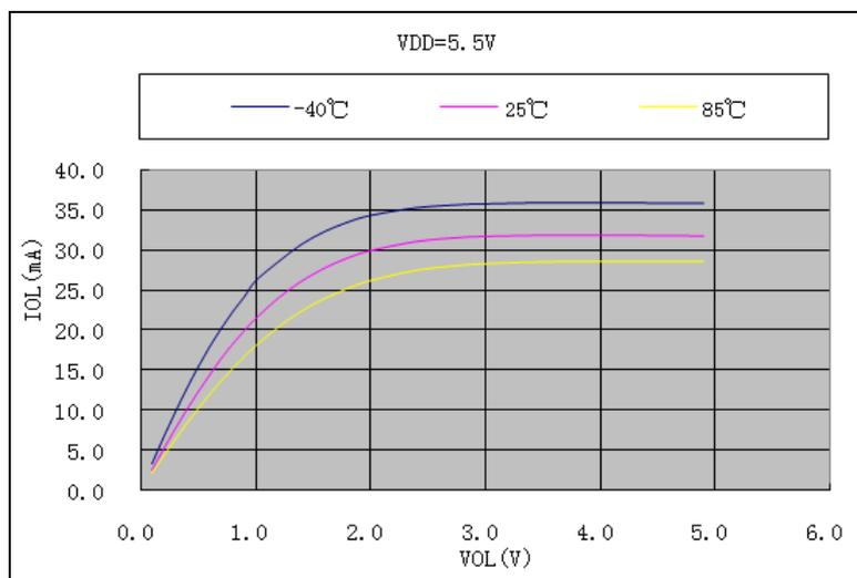
附录4.2.4 芯片IO端口增强驱动输出特性 (PC0, PB0~PB3, PA0~PA2 端口)
