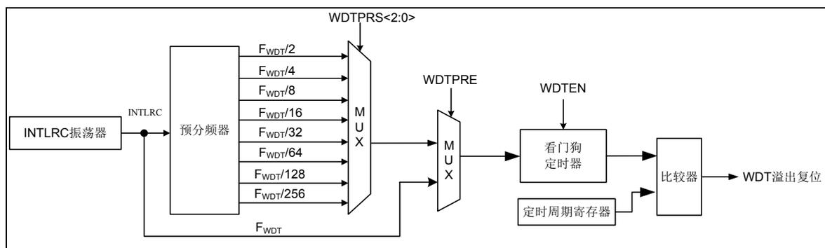
图 5-2 看门狗定时器内部结构图
