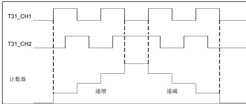
图 6-31 编码器模式下的计数时序 (T31SM=010, 通道输入不反相)
