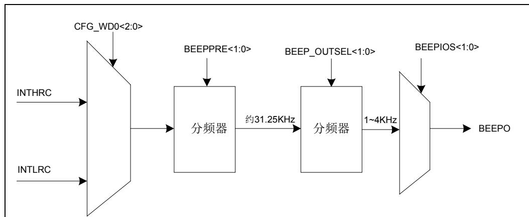
图 5.1 BEEPER 结构图
