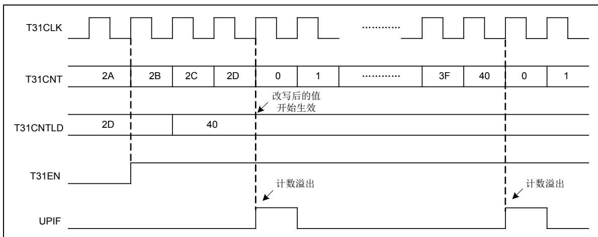
图 6-16 递增计数时序图 (RLBE=1, T31CNTLD 有缓冲)
