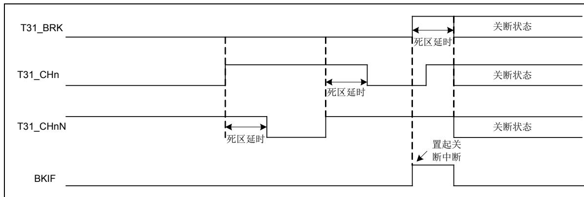
图 6-30 带死区互补输出的关断时序图
