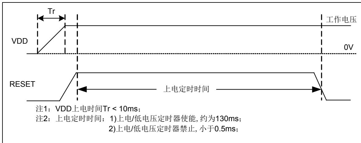
图 5-4 上电复位时序示意图
