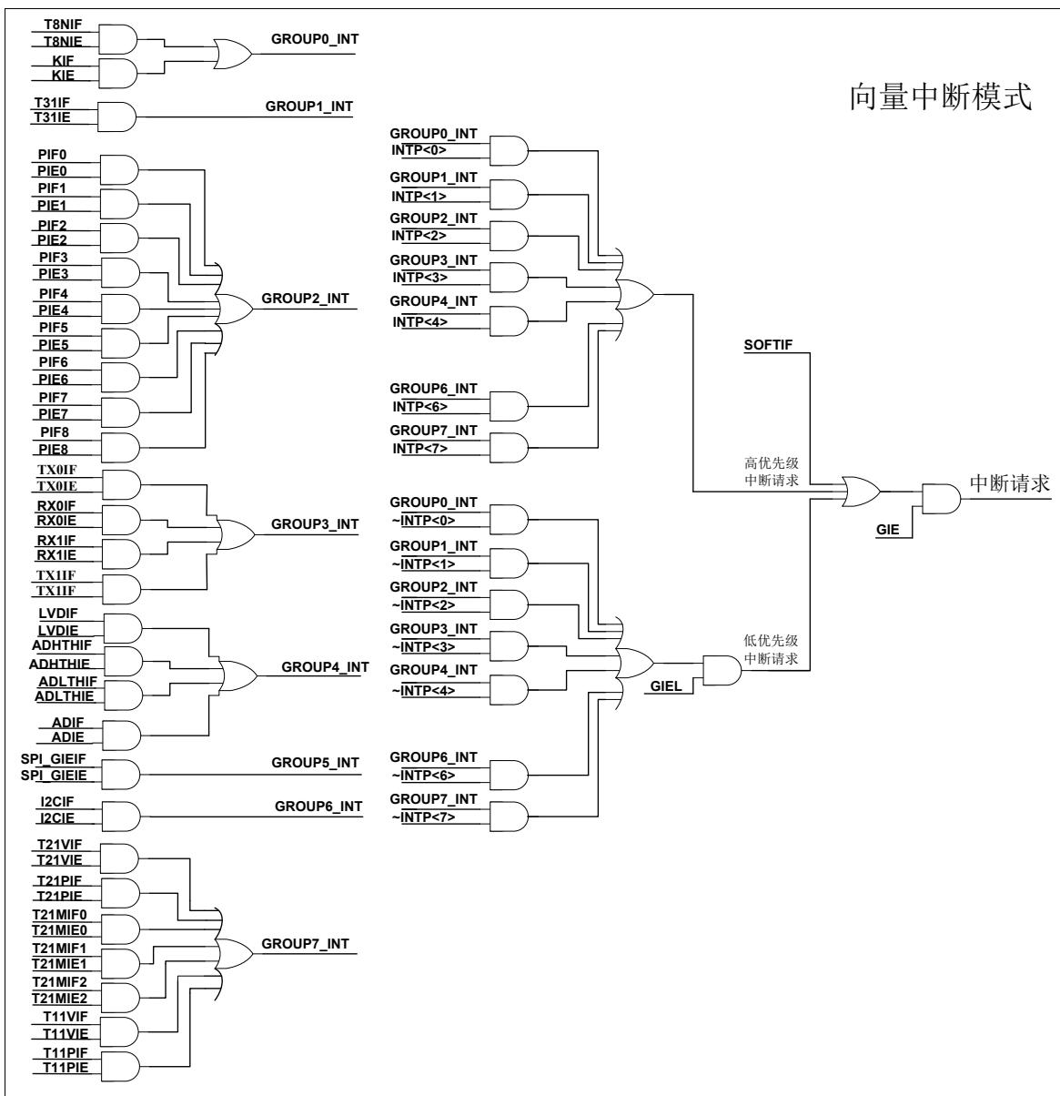
图 7-2 向量中断模式中断控制逻辑
