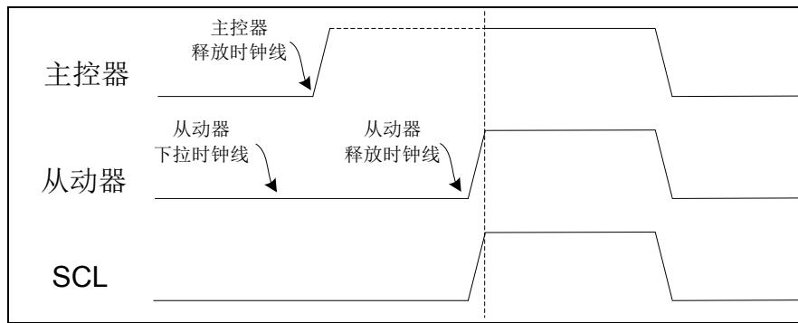
图 6-52 I2C 时钟线下拉等待波形示意图
