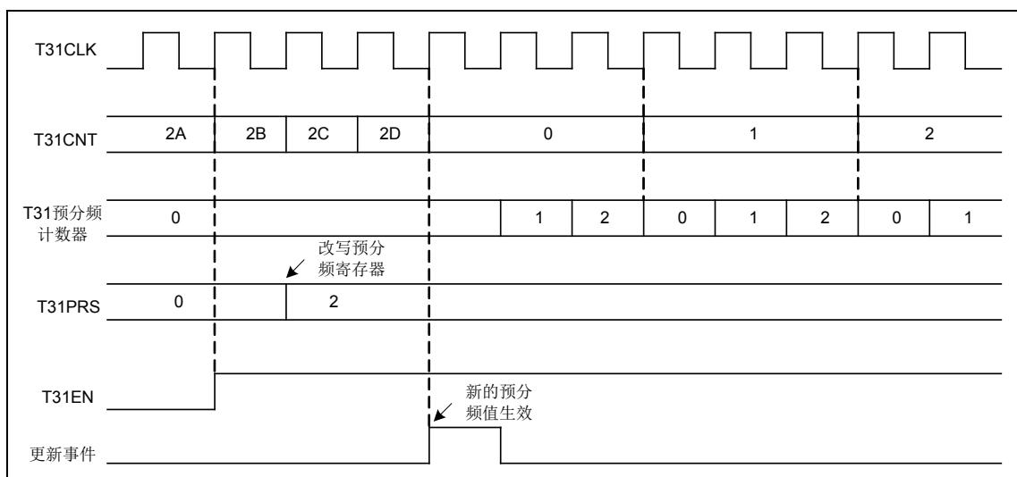
图 6-13 预分频比变更的计数时序图 (T31CNTLD=0x2D)
