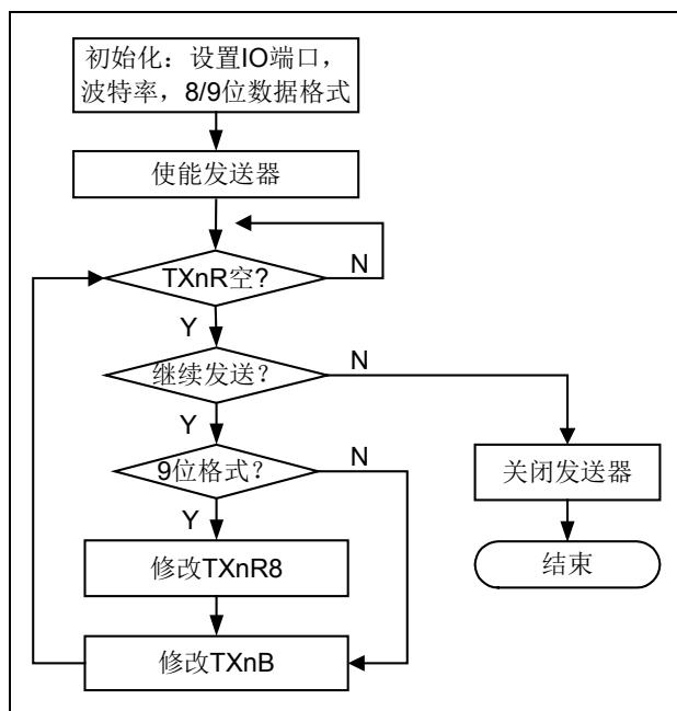
图 6-38 UARTn 发送器操作流程图
