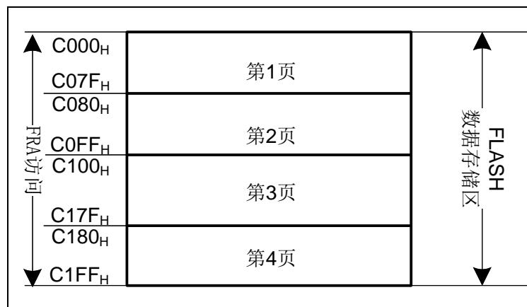
图 3-2 FLASH 数据存储区寻址空间映射图
