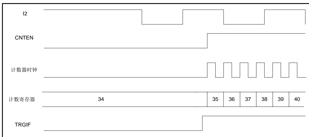
图 20-26 触发模式控制电路
